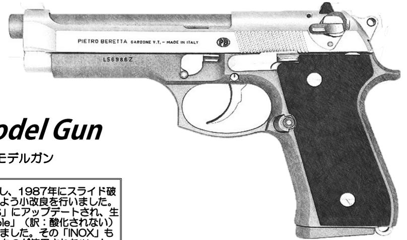
ベレッタ社は1983年に「92SB」を改良した「92SB-F」を開発し、1985年に「M9」として米軍に採用されました。しかし、1987年にスライド破断事故が発生し、安全対策としてハンマーピンを大型化し、方がスライドが破断しても、溝から外れ停止し後方に飛んでこないよう小改良を行いました。この改良を民間モデルでも行い、「92F」から「92FS」と呼ばれるモデルとなります。本国イタリアでも「92F」から「92FS」にアップデートされ、生産が続けられました。その92FSに1990年に新たなバリエーションとして「INOX」が発表されます。「INOX」は「Inoxidizable」（訳：酸化されない）の略で、その名前の通りスライド・バレルがステンレスで製作され、さらにフレームもシルバーカラーのアルマイト処理がなされました。その「INOX」も30年近い歴史の中でバージョンアップなどが行われ、現在流通している「INOX」はコントロールレバー類に黒色の通常モデルのものが使用されたツートンモデルとなっています。
